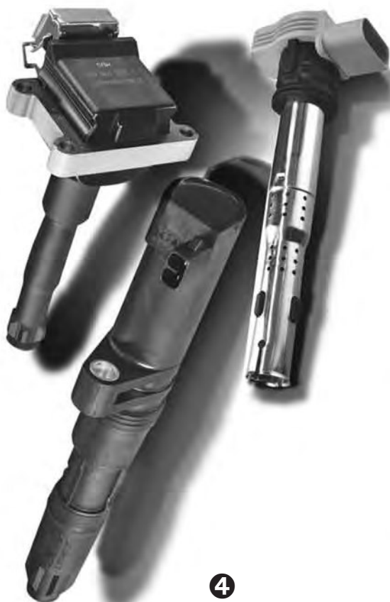
4 Verschillende uitvoeringen van staaf-/stekkerbobines voor voertuigmodellen van BMW, Fiat, Mercedes-Benz, Porsche, Renault of VW.
