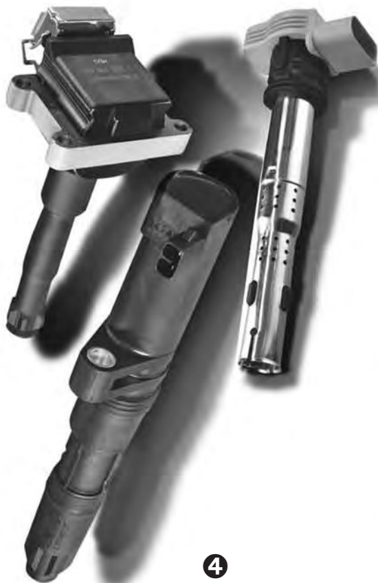
Différents modèles de bobines d'allumage à fût de bougie / avec embout pour les modèles de véhicules de BMW, Fiat, Mercedes-Benz, Porsche, Renault ou VW.
