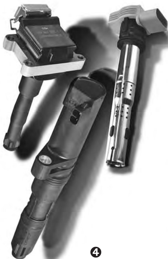
Διάφορες εκδόσεις πηνίων ανάφλεξης για υποδοχή μπουζί και πηνίων ανάφλεξης με συνδετήρα για μοντέλα BMW, Fiat, Mercedes-Benz, Porsche, Renault ή VW.
