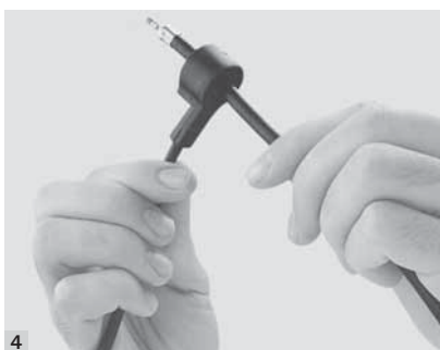
4 Le câble d'allumage peut être glissé ainsi avec le connecteur M3 au travers du générateur d'impulsions. Zo kan de ontstekingsleiding met de M3-aansluiting door de impulsensor geschoven worden.
