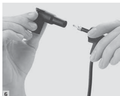
6 Finalement, vissez le connecteur de l'allumeur du CopperCable. Tenslotte de stekker van de ontstekingsverdeler van de CopperCable er opschroeven.
