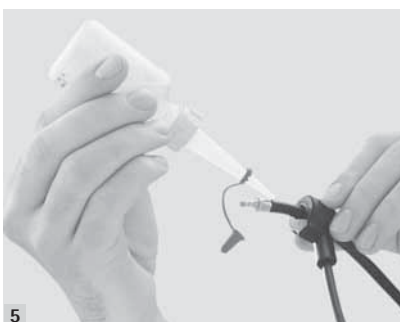
5 Enduisez maintenant le câble d'allumage d'huile de montage. Nu de ontstekingsleiding met montageolie insmeren.
