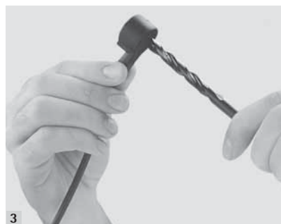
3 Percez le générateur d'impulsions sur 8 mm (tournez la mèche à la main). De impulsensor tot 8 mm opboren (boor met de hand draaien).
